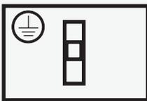
È responsabilità dell'utente accertarsi che il condizionatore sia connesso col cavo di messa a terra secondo le norme vigenti locali e che l'operazione sia realizzata da un tecnico specializzato.
