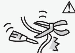
Non tirare o premere il cavo dell'alimentazione elettrica per evitarne la rottura. Ciò può causare scosse elettriche o incendi provocati dalla rottura del cavo di alimentazione
